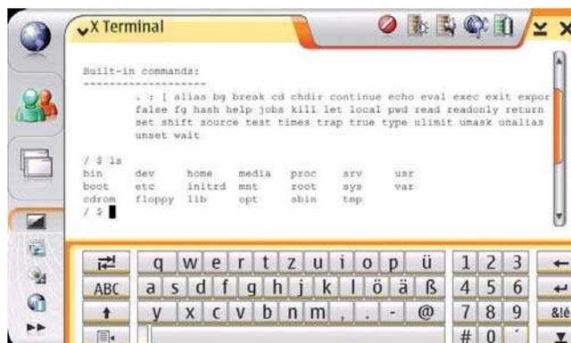
**Zum Admin-Werkzeug wird das N770, wenn der Shell-Zugriff mit X-Term und SSH für die Fernwartung installiert ist**
