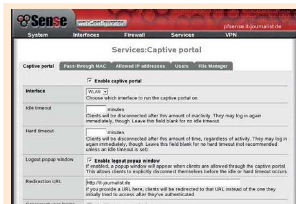
Mit pfSense wird aus einem PC eine Firewall mit WLAN-Access-Point. Den Zugang regelt das Captive Portal
